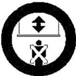
**Generell und speziell während des Ein- und Ausfahrens ist der Aufenthalt unter der Lichtbildwand untersagt!**
